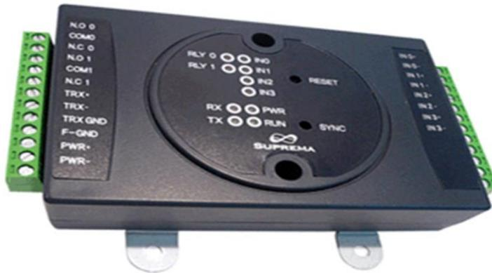
El módulo de expansión brinda puertos de entrada y salida adicionales para aplicaciones de control de acceso. Provisto de comunicación cifrada, proporciona una forma segura y cómoda de escalar las funciones de control de acceso de los terminales. Hasta cuatro unidades Secure I/O pueden agregarse a un terminal, lo que equivale a adicionar ocho (8) relés y diecisésis (16) sensores adicionales.
